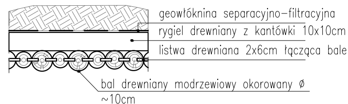
DETAL1a: ŚCIANA A Z BALI DREWNIANYCH W TUNELU 1:20
